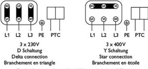
Drehrichtungsänderung durch Vertauschen von 2 Phasen Changing of direction of rotation by interchanging of two phases Changment de sens de rotation par inversion de deux phases
